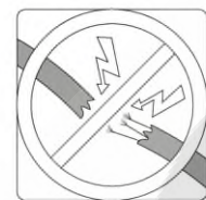
Controllare i cavi danneggiati
