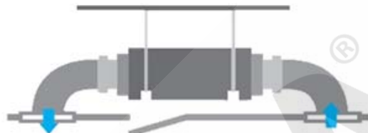
Preso d'aria posteriore e mandata diretta (STANDARD)
